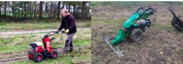
De zode afplaggen met een zodensnijder (links). Messenbalk (rechts).
